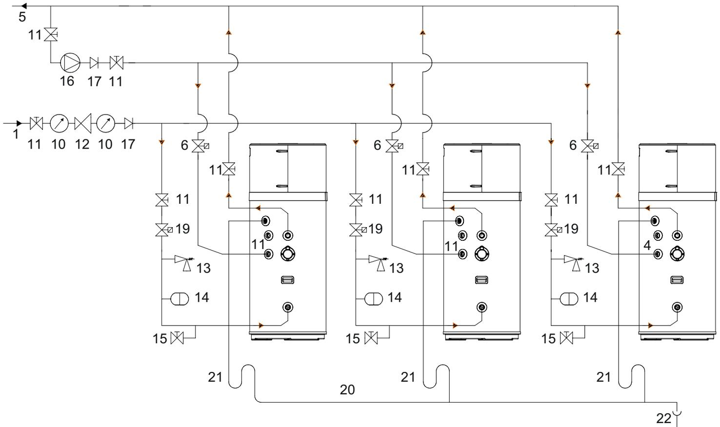
fig. 61 - Esempio impianto idrico SENZA valvola miscelatrice termostatica
