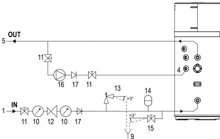
fig. 58 - Esempio impianto idrico SENZA valvola miscelatrice termostatica
