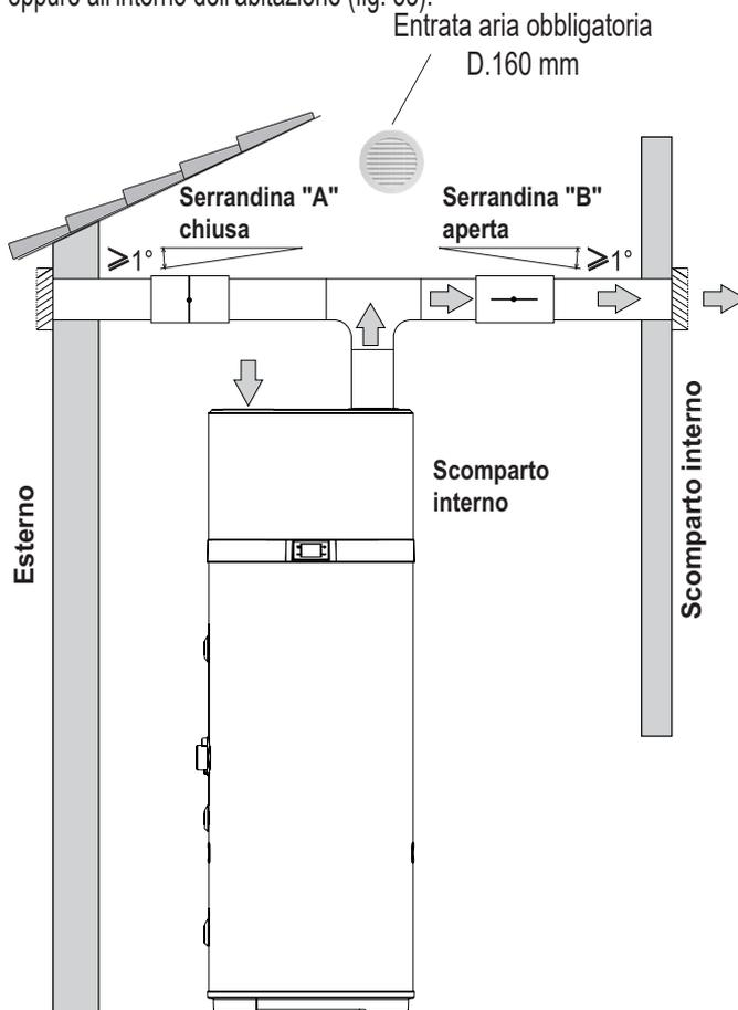
fig. 55- Esempio di installazione nel periodo estivo
