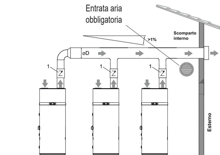
fig. 54 - Esempio di collegamento scarico aria
