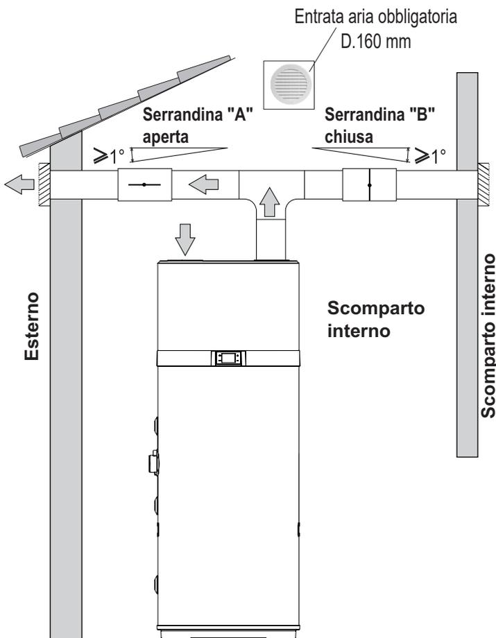
fig. 56- Esempio di installazione nel periodo invernale
