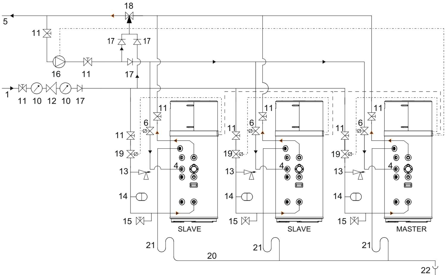
fig. 63 - Esempio impianto idrico CON valvola miscelatrice termostatica (ricircolo su connessione ricircolo acqua unità)
